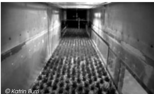
© Katrin Burri Winderosions-Experiment im Windkanal am SLF in Davos
